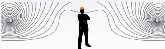
La colocación ideal del detector en la parte alta de los cascos de protección permite detectar con la misma eficacia un campo eléctrico, tanto si se encuentra delante o detrás de la persona que lo lleva.
